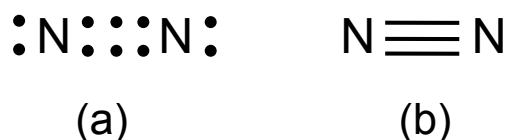
図 9 窒素分子 N_2 の構造. (a)点電子図, (b)結合図.
